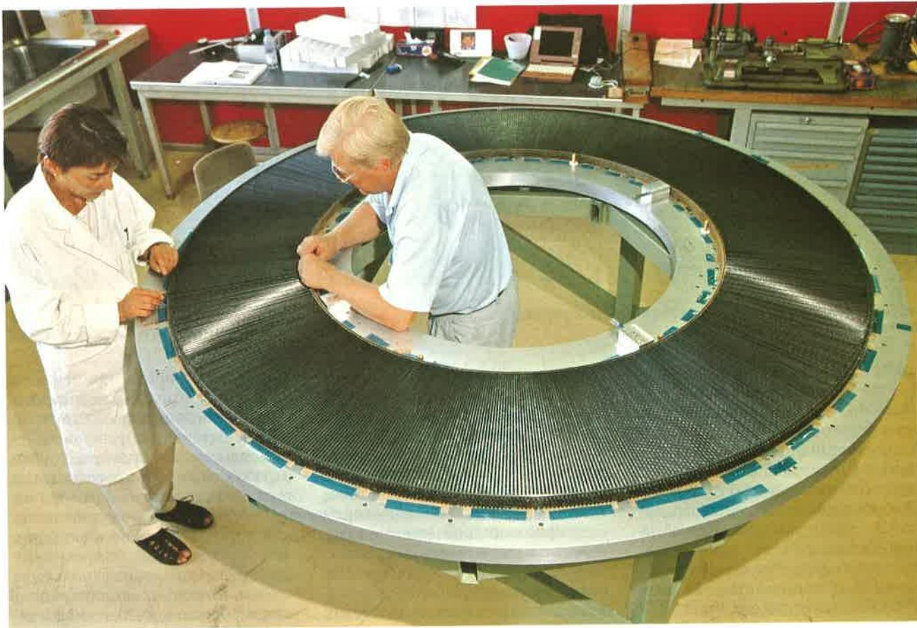
Принцип работы детектора заключается в следующем. Частица, проходя через трубку, ионизирует газ, и оторвавшийся электрон начинает перемещаться (дрейфовать, поэтому трубка называется дрейфовой) к аноду. Возникший сигнал считывает специальная быстродействующая аппаратура и формирует информацию о времени прихода частицы (около 1 нс), ее координате (с точностью около 100 мк), импульсе и типе.
