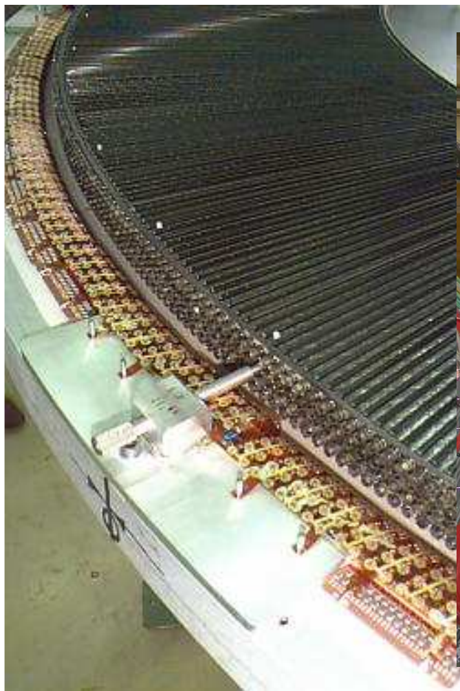
Регистрирующие элементы трекового детектора переходного излучения - тонкостенные газонаполненные трубочки
