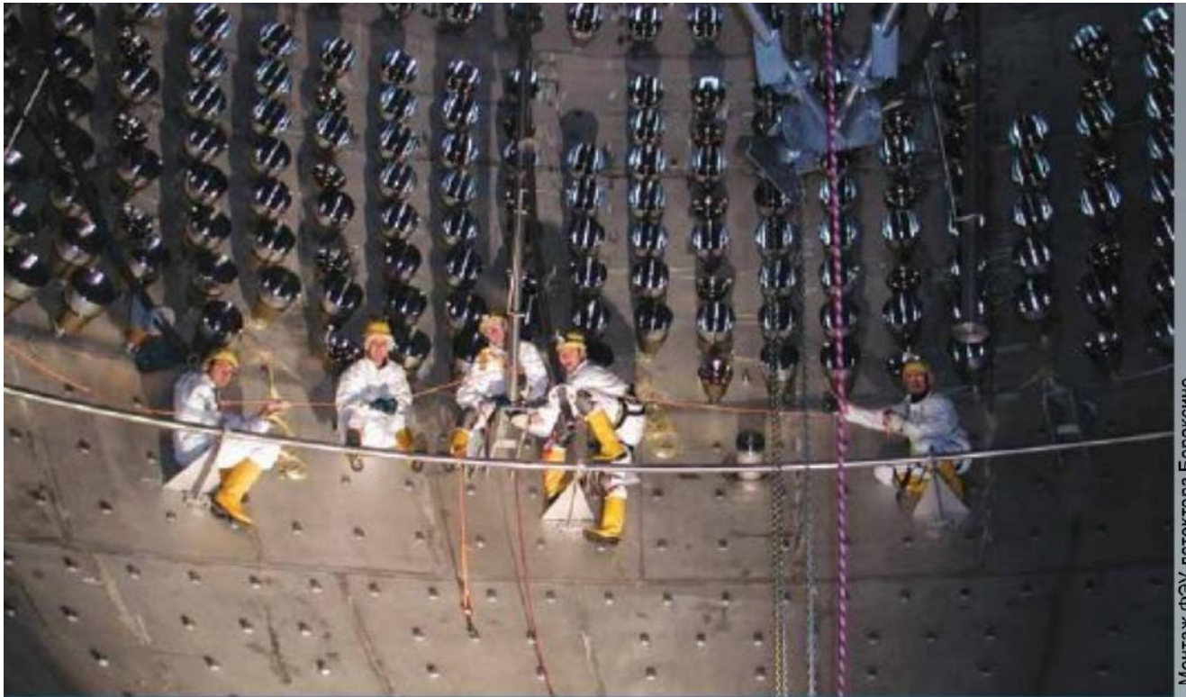
Монтаж ФЭУ детектора Борексина
